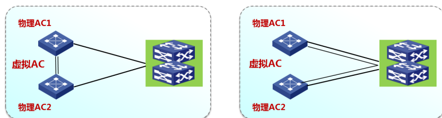
图 2 AC 虚拟化原理图
