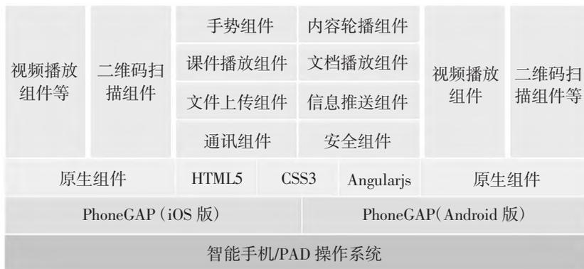
图3 系统移动端技术架构
