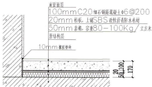
图10 设备机房浮筑地面做法
